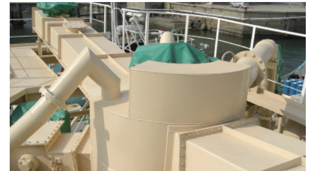
分配タンク Distributing tank
